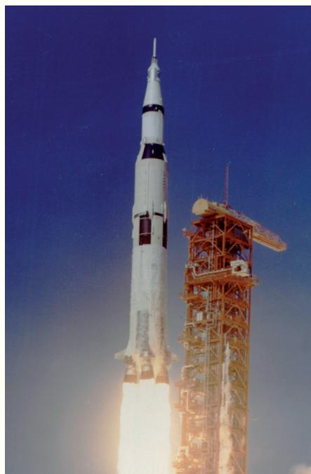
Wernher von Brauns Rakete Saturn V war so perfekt entworfen und gebaut, dass sie zur zweimal unbemannt getestet werden musste und nicht ein einziges Mal versagte. Sie hatte die unglaubliche Startmasse von knapp 3.000 Tonnen.
